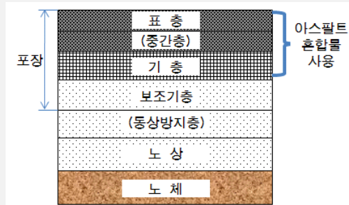
〈 아스팔트 콘크리트 포장 단면 구성 〉
