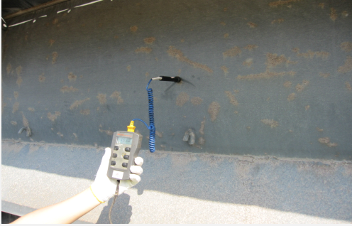
〈 운반장비의 적재함 옆면 중앙부의 혼합물 온도 측정구 및 측정 〉
